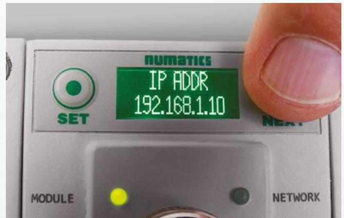
L'électronique G3 propose une solution distribuée permettant une topologie en ligne ou en étoile, réduisant la longueur des câbles et le nombre de connexions pneumatiques, ce qui baisse les coûts et améliore les performances. Elle fournit également une large gamme d'Entrées/Sorties, y compris analogiques, numériques (Tout ou Rien) et de température (PT100)
